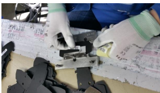
Pose d'étiquettes sur plaquettes de freins – Métalis
